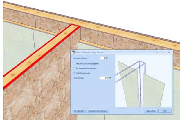
Ist kein Haken gesetzt, wird die Platte an der oben eingestellten Schicht getrennt
