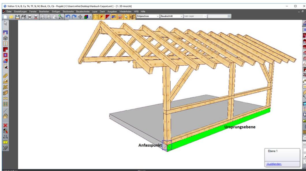
Nun können mit der gleichen Vorgehensweise Schwellen, Säulen und Kopfbänder in den Giebelwänden erzeugt werden. Die Holzteile können nun auch angeschnitten oder mit Holzverbindungen versehen werden. Diese Funktionen werden weiter vorne im Handbuch beschrieben.
