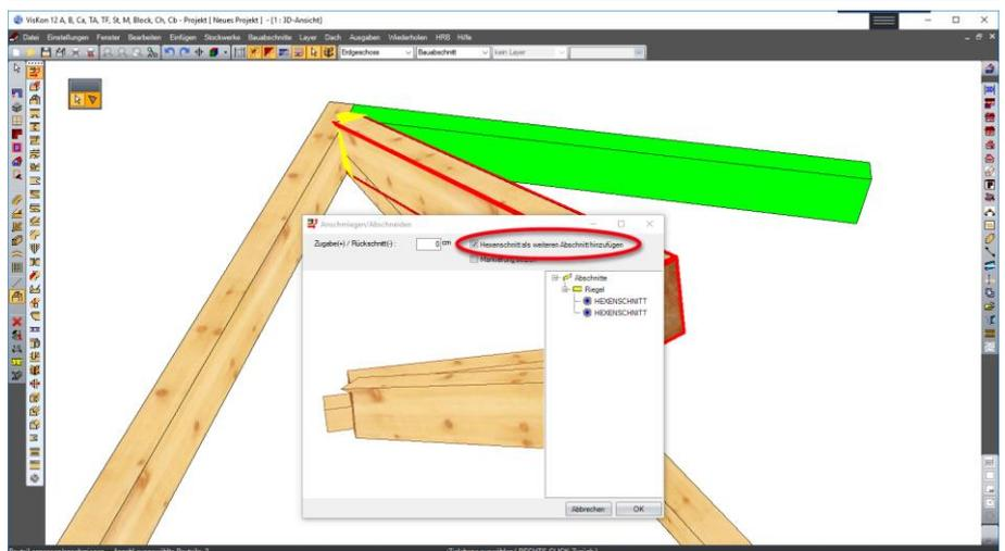
Als dritter und letzter Arbeitsschritt wird nun das schräge Holz auf den darunterliegenden Balken angepasst. Hierzu das schräge Bauteil mit der vorigen Funktion auf den Balken anpassen und ebenfalls den Haken bei „Sägeschnitt als weiteren Abschnitt hinzufügen“ setzen, um einen weiteren Abschnitt hinzuzufügen. Das Bauteil müsste nun in der Einzelholzansicht mit vier Abschnitten versehen sein.
