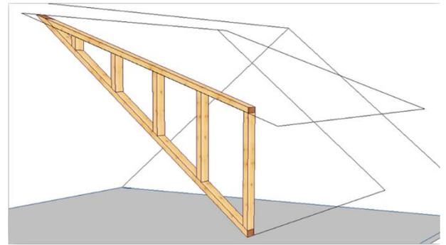
Mit dieser Funktion ist es möglich, bearbeitete oder selbst erzeugte Kanten mit den entsprechenden Schichtkantentypen zu belegen, dass Sie wie im Beispiel die benötigten Schwellen oder Rähme automatisch bei Teilung erzeugen lassen können. Somit können nun auch Gaubenwände automatisch ausgeteilt werden.
