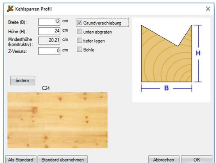
Wird der Haken gesetzt bei Bohle, ändert sich das Eingabefenster für die Kehlbohle. Neben den Abmessungen der Kehlbohle kann eine Auflagerhöhe zur Hauptdachfläche sowie die Auflagerfläche eingestellt werden. Eine Abgratung kann optional eingestellt werden. Das Material kann über den Button ändern eingestellt werden.
