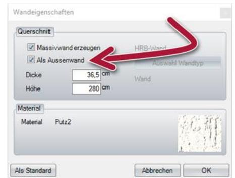
Bei Massivwand kann auch zwischen Außenwand und Innenwand unterschieden werden, damit das in den Listenausgaben und Beschriftungen entsprechend berücksichtigt werden kann.
