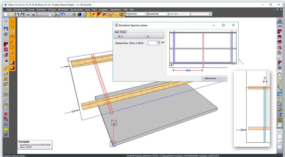
Der Bereich dazwischen wird mit der Funktion Teilen mit variablem Achsmaß aufgeteilt.
