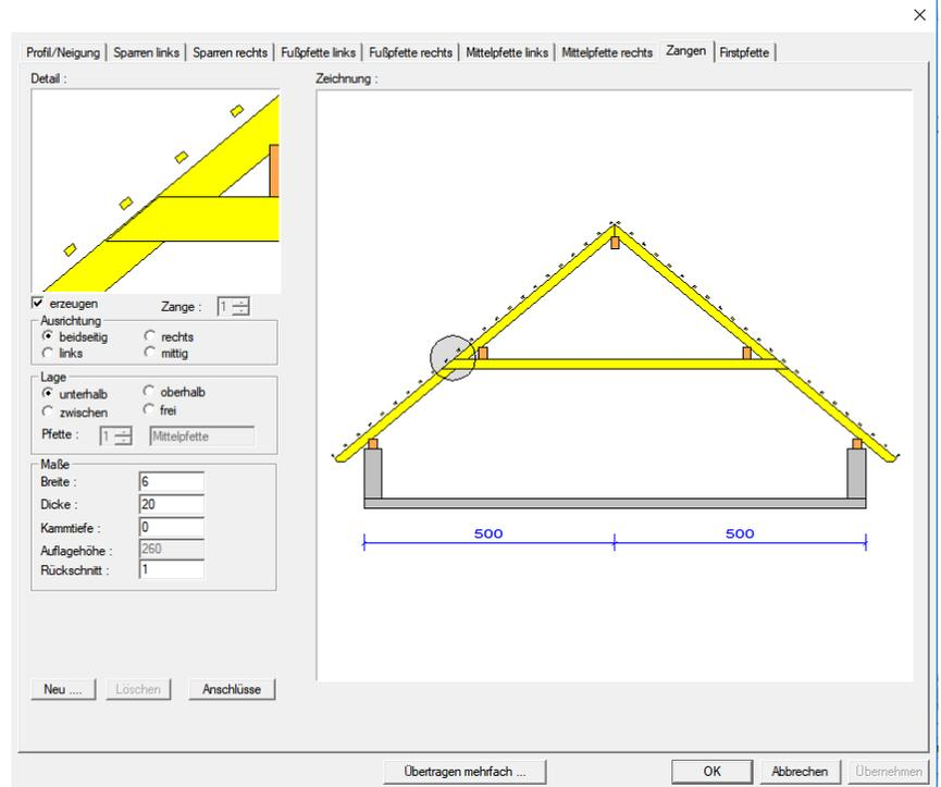
**Maße:** Hier werden die Abmessungen der Zange eingegeben. Es kann eine Kammtiefe bestimmt werden, um die Zange auszublaten. Ein Rückschnitt zur Sparrenoberkante kann ebenfalls definiert werden.
