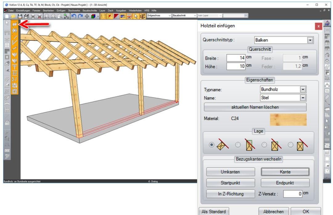
Ein weiteres „paralleles“ Holzteil wird erzeugt mit der Schwelle als Bezugskante und einem Abstand von einem Meter. Dieses wird als Riegel definiert.
