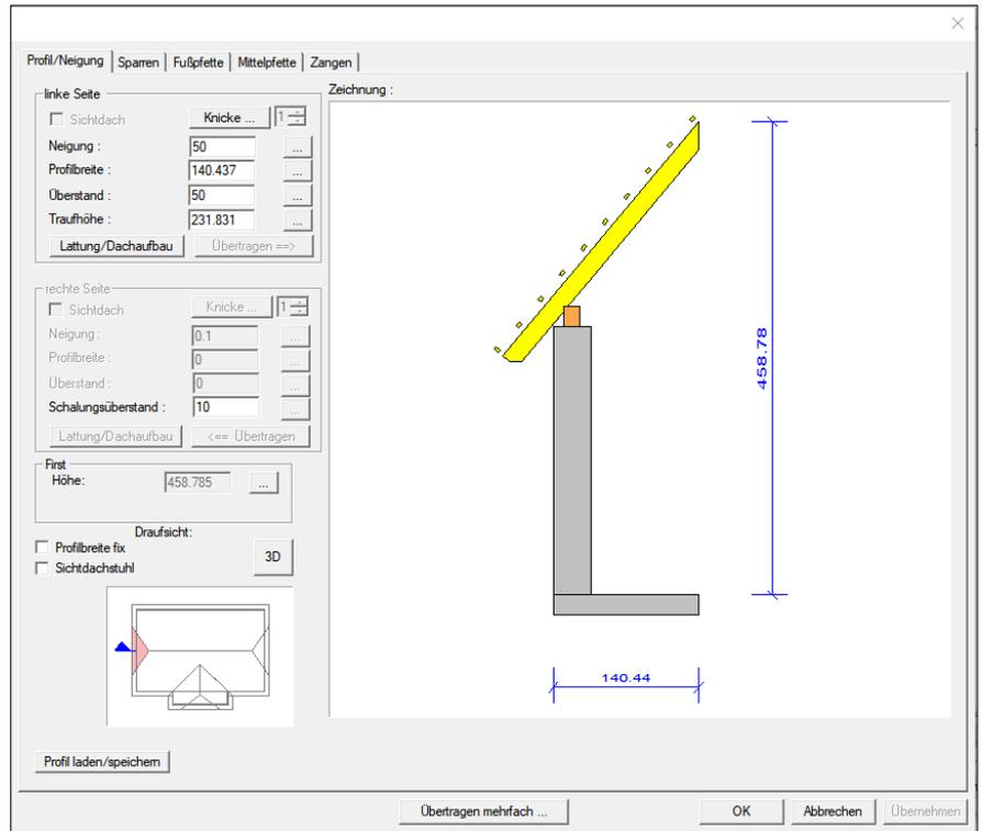
In den Eigenschaftsseiten „**Profil/Neigung**“, „**Sparren**“, „**Fußpfette**“, „**Mittelpfette**“ und „**Zangen**“ können Sie wie beim Hauptdachprofil die Werte für Profil und Holzkonstruktion eingeben.
