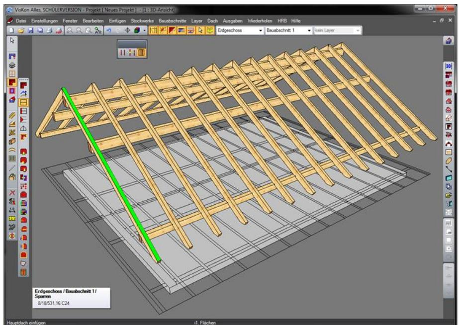
Anschließend wird die Dachfläche durch Dachflächenlinien angezeigt.
