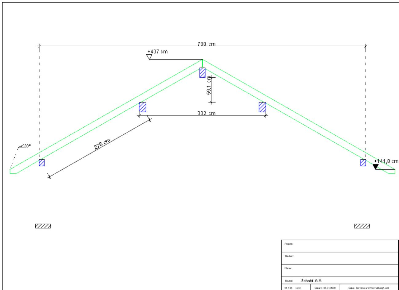
Ebenso können Mehrfachvermaßungen erstellt werden. Den Button hierfür finden Sie ebenfalls in der linken Leiste im ausklappenden Fenster bei der „**Einzelvermaßung**“.
