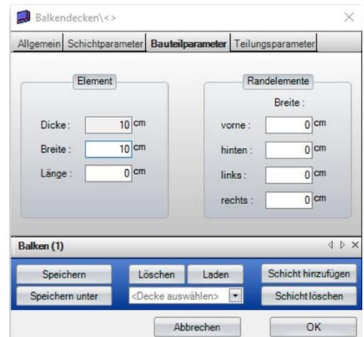
**Randelemente:** Hiermit lassen sich Randelemente, z.B. Randbalken, automatisch erstellen.
