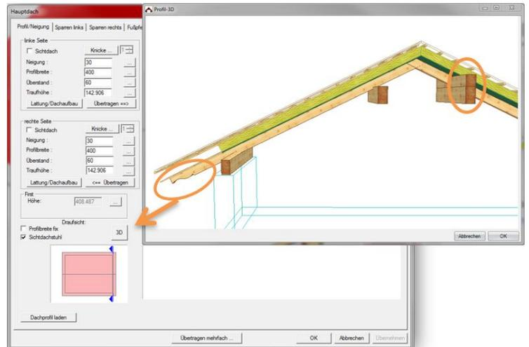
Es gibt im Profil 3D zwei Reiter, „**Traufschalung**“ und „**Hobeln**“, über die man bereits im Profil eine gewünschte Traufschalung, Sparren- und Pfettenhobelungen voreinstellen und nach dem Verlassen des Eingabedialoges mit F5 automatisch erzeugt werden kann.
