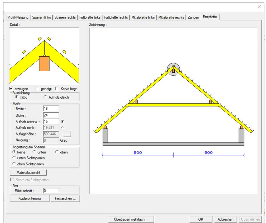
**Aufholz senk.:** Durch Setzen des Punktes hinter dem Eingabewert kann das Aufholz auch senkrecht eingegeben werden.
