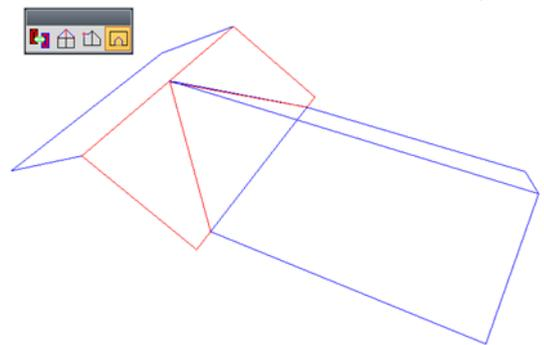
Diese Bearbeitungen erleichtern die manuelle Anpassung von Anbauten oder Walmflächen, die beispielsweise auf eine vorhandene Dachfläche angepasst werden soll. Die Dachfläche kann sich in einem anderen Bauabschnitt befinden, damit eine separate Holzliste von beiden Dachflächen erstellt werden kann.
