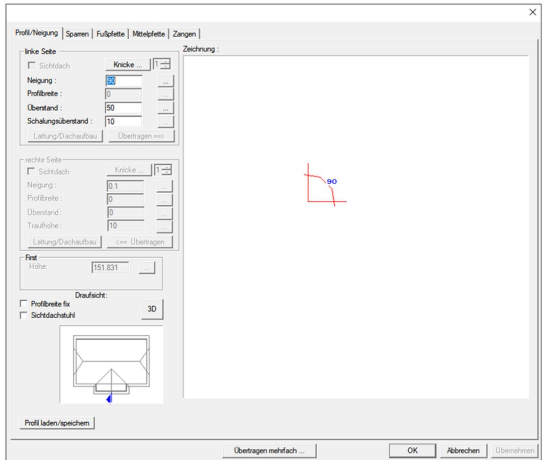
Bevor Sie das Dach im Assistenten fertigstellen, entfernen Sie bitte bei Schritt 6 den Haken bei Sparren automatisch. Die Sparrenteilung wird bei diesem Projekt manuell erzeugt. Nachdem Sie mit Hilfe des Dachassistenten das Walmdach erzeugt haben, setzen Sie es mit der Maus im Visikon an eine Kante der Bodenplatte ab.
