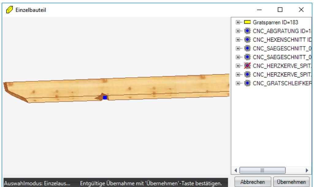
**Achtung:** Auch nach Löschen eines Zapfens ist das Zapfenloch immer noch im angrenzenden Bauteil vorhanden, da das Zapfenloch im anderen Bauteil liegt.
