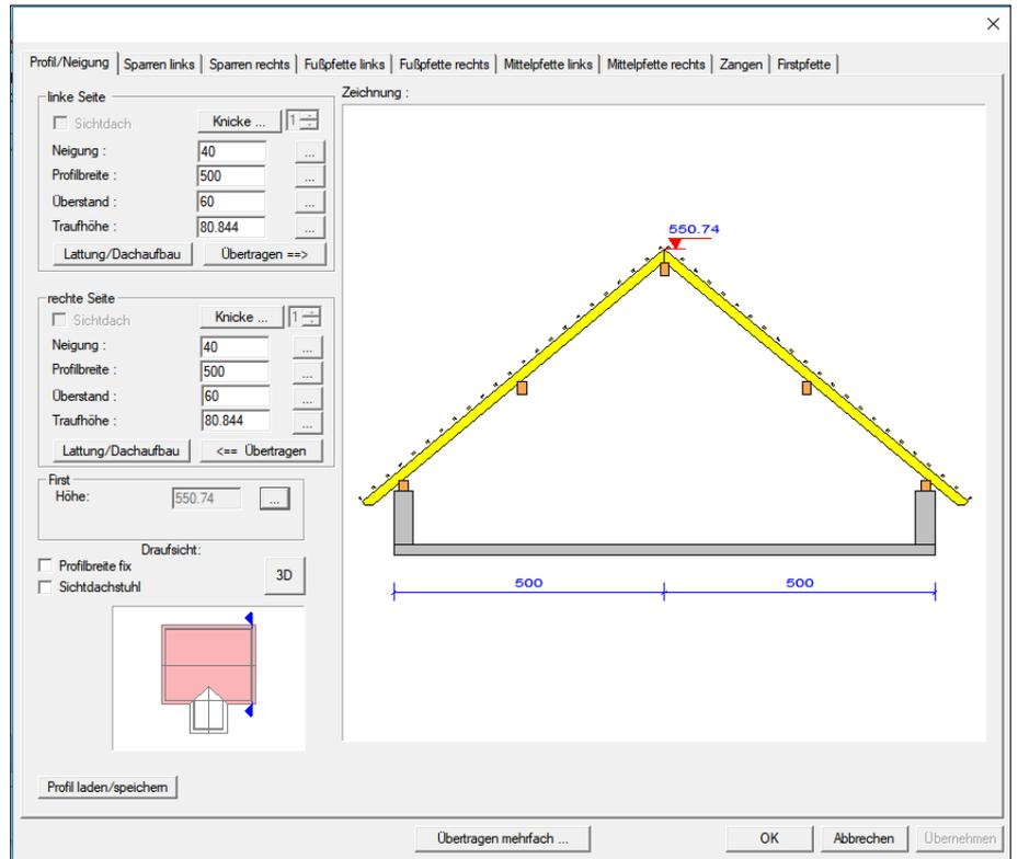
Über den rechteckigen Schalter hinter dem Eingabefeld kann eine Berechnungsfunktion aufgerufen werden.
