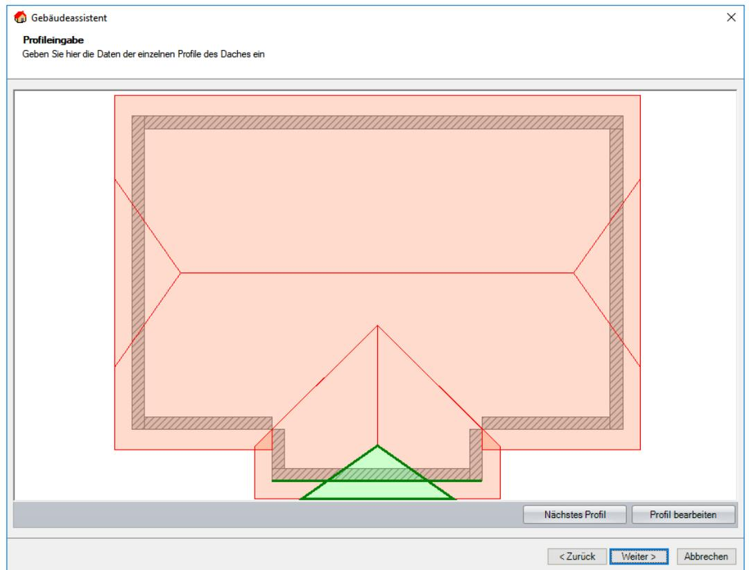
In der Profileingabe setzen Sie die Neigung des Anbauwalms auf 90 Grad; somit wird hieraus ein Ortgang.
