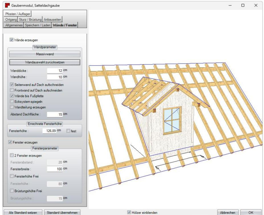
**Sturz:** Hier können die Größe sowie die Lage des Sturzholzes angegeben werden. Außerdem kann ein Einschnitt in die Pfette, sowie ein seitlicher Überstand definiert werden.
