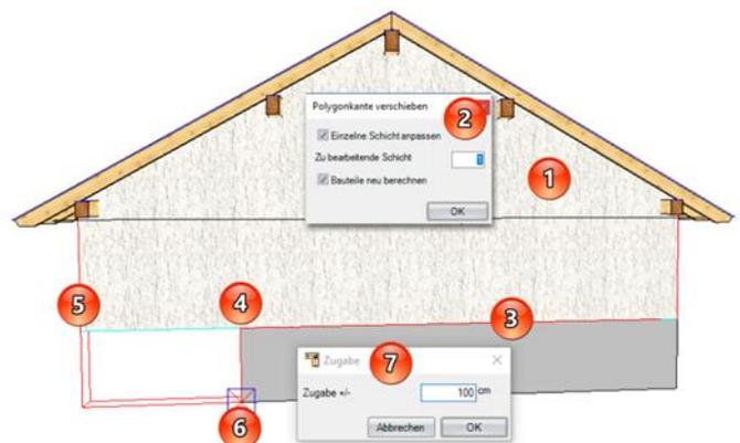
Die Teilkanten-Bearbeitung ist so aufgebaut, dass über ein Abfragedialog entschieden werden kann, ob die Teilkantenverschiebung rechtwinklig oder im vorhandenen Kantenverlauf vorgenommen werden soll. So kann zum Beispiel die Anpassung der Wände im Pfetten-Bereich einfacher umgesetzt werden.
