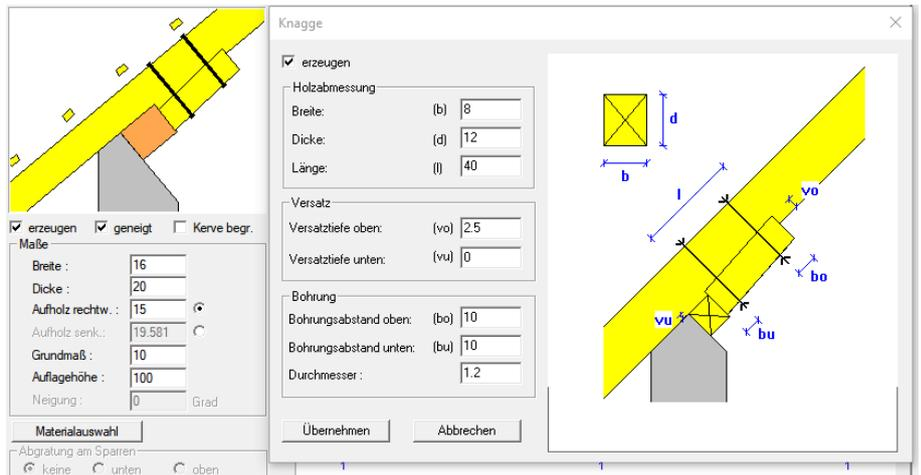
**Aufholz senk.:** Durch Setzen des Punktes hinter dem Eingabewert kann das Aufholz auch senkrecht eingegeben werden.
