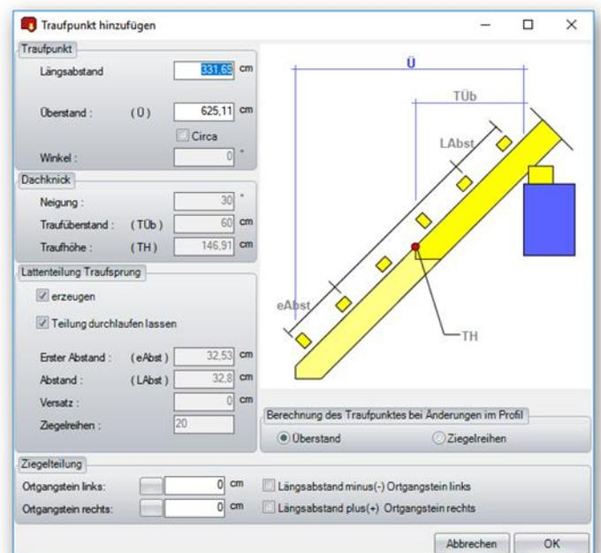
Traufabsatz bestehen bleibt (Überstand wird mehr) oder der Überstand bestehen bleibt (Ziegelreihen im Traufabsatz werden weniger).
