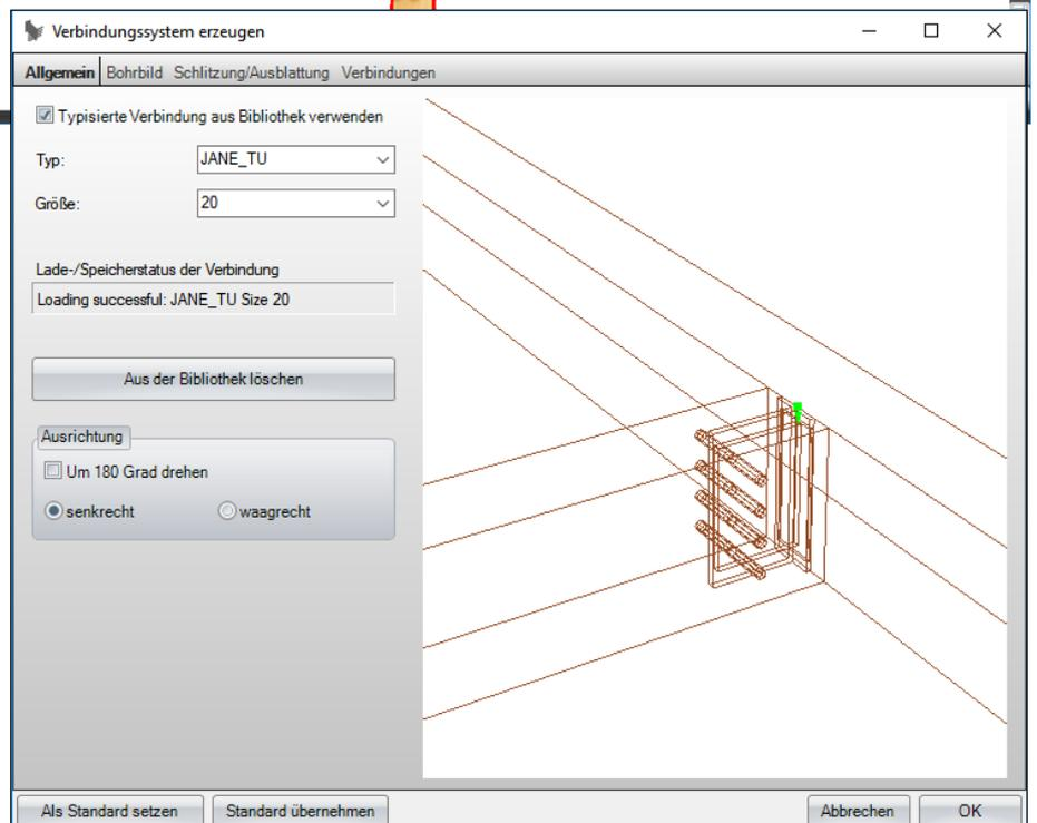
Mit Hilfe des Drahtgittermodells können die Verbindungen am Besten kontrolliert werden.
