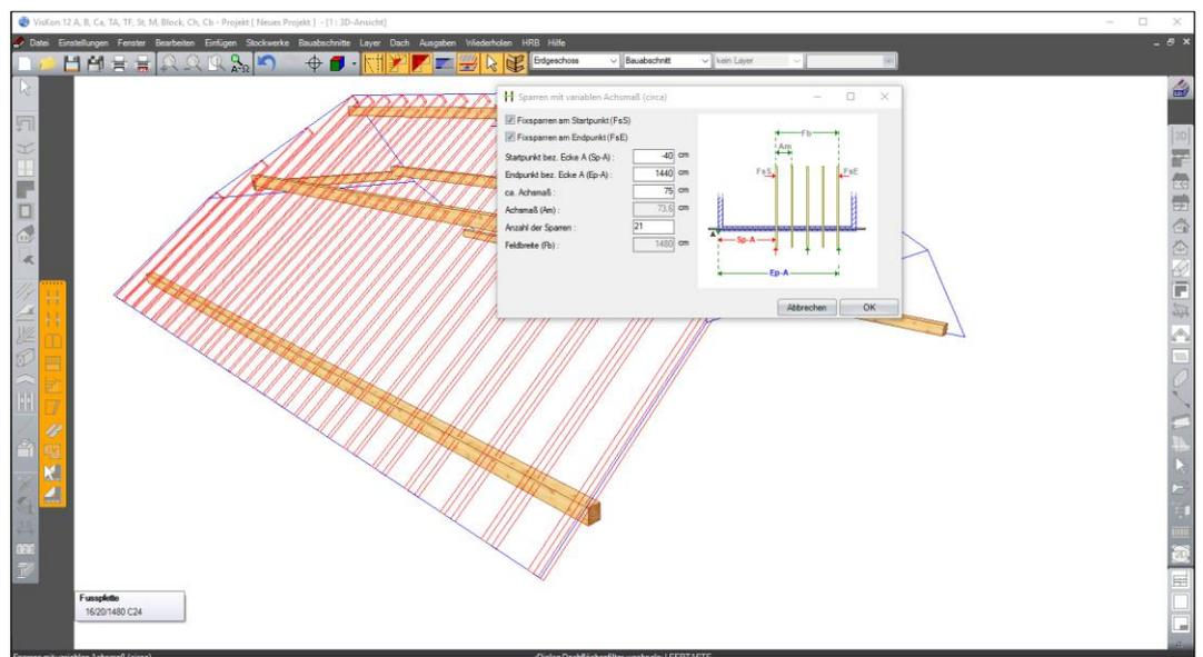
Anschließend diesen Prozess durchführen, bis alle Sparrenfelder eingeteilt sind. Erst nach Drücken der F5-Taste werden die Abschnitte und Kerne aus dem definierten Profil übernommen. Das fertige Projekt sollte wie folgt aussehen:
