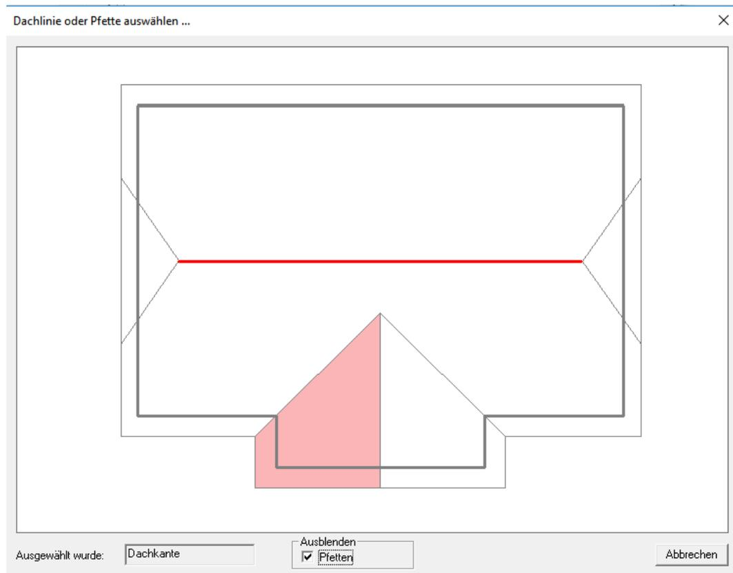
Wählen Sie als Anpassungsmethode **Drehpunkt Traufe = fest** und klicken wieder auf den Schalter hinter der Firsthöhe. Anschließend öffnet sich ein Fenster, in dem Sie mit der Maus die neue Firsthöhe auswählen können. Nachdem Sie auf die entsprechende Kante geklickt haben, schließt sich das Fenster und die Höhe der Kante wird als Maß übernommen. Damit die Firstkante besser angeklickt werden kann, ist es möglich, die Pfetten auszublenden.
