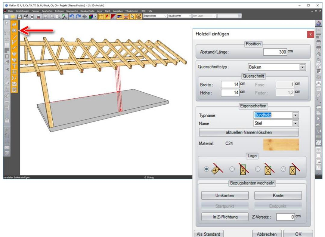
Zum Erzeugen der Schwelle werden die Wände ausgeblendet. Mit der Auswahl an Bundseite ausgerichtet wird die Schwelle über zwei Punkte erzeugt.
