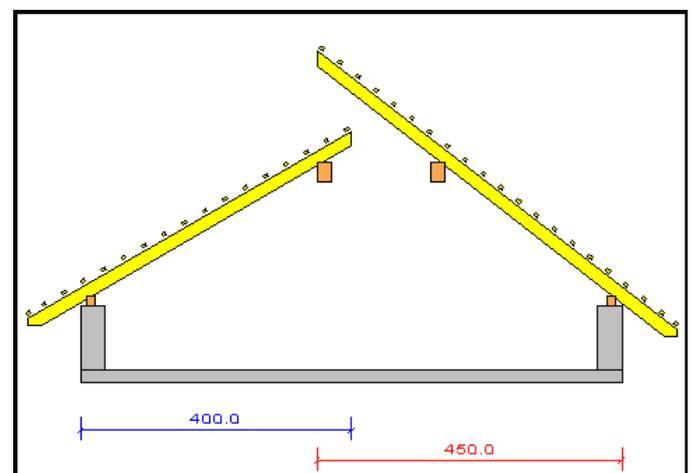
Es ist auch möglich, im Profil einen separaten zweiten Firstabschnitt über Winkel und Länge für Walmflächen zu definieren. Auch kann ein Winkel für den Senkelschnitt am First verwendet werden
