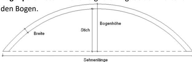
Mit dem Längsmaß lässt sich der Startpunkt des Bogens verändern. Die Bezugskante am Bauteil kann ebenfalls gewechselt werden.
