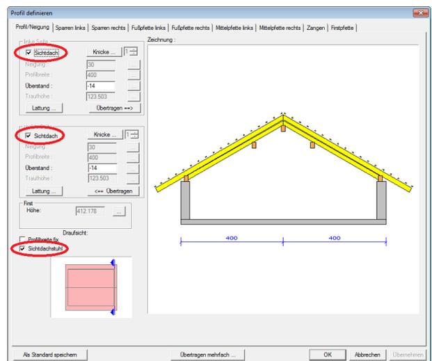
**Fußpfette links/rechts:** Das Aufholz wird zu Oberkante Sichtsparren berechnet. Optional lässt sich die Kerbe auch am Sichtsparren setzen.
