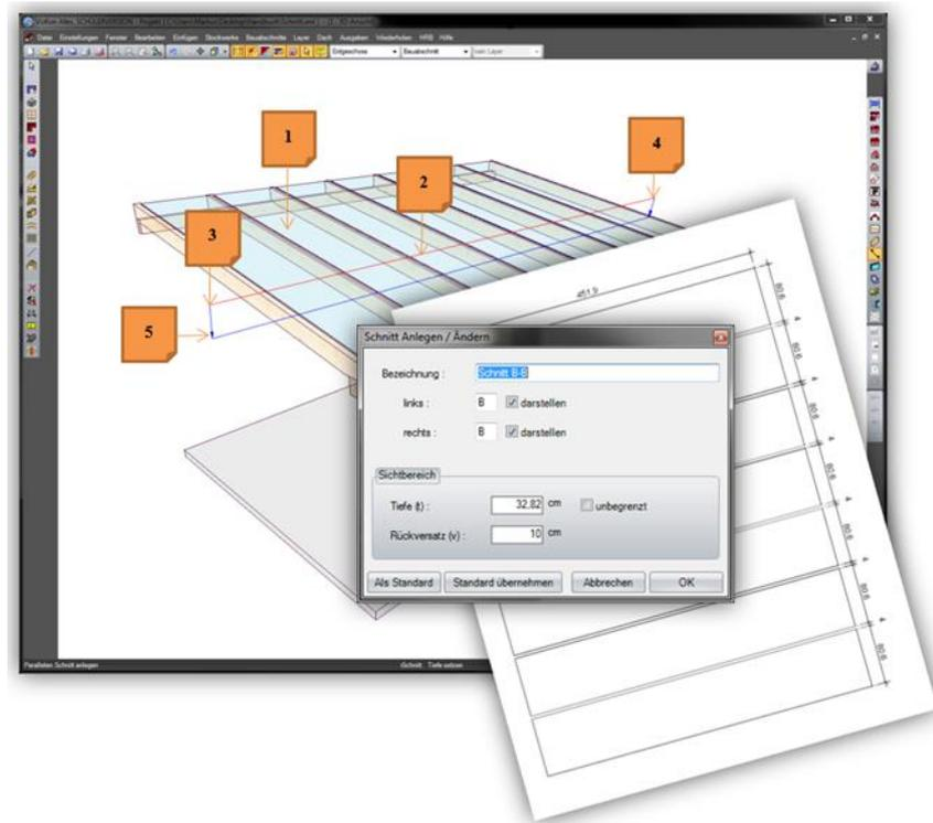
In diesem Beispiel wurde eine Draufsicht der Platten erzeugt, die in dieser Ansicht dann vermaßt werden kann.
