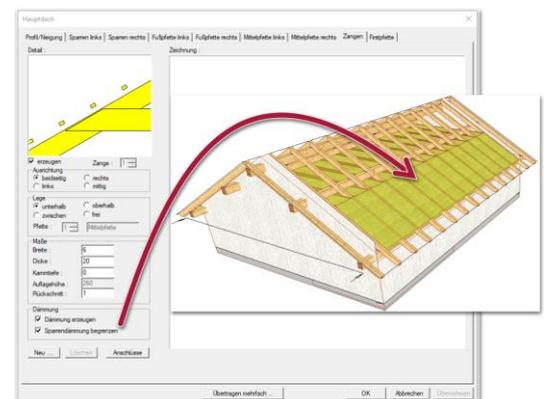
**Neu:** Hier kann eine neue Zange zu einer evtl. zweiten Mittelpfette angelegt werden. Die Anordnung der Zangen bei mehreren Mittelpfetten erfolgt in der Eingabebox Lage, in der die zugehörige Mittelpfette ausgesucht wird. Werden zwei Zangen aufeinander gesetzt, erscheint eine Fehlermeldung und die aktuelle Zange wird als freie Zange an einer freien Stelle im Dach gesetzt, von wo sie wieder neu positioniert werden kann.
