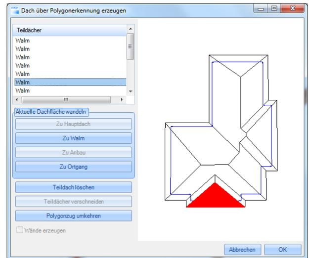
Wurde eine Platte ausgewählt, lassen sich über diese Funktion die Wände gleich miterzeugen. Über Polygonzug umkehren, kann die Richtung der Dachflächen umgedreht werden.
