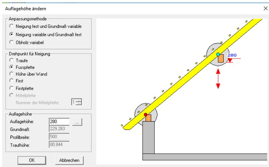
**Grundmaß:** Hier kann das Grundmaß der Mittelpfette von Außenkante Wand eingegeben werden.
