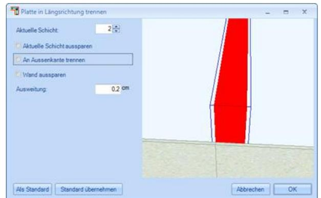
Ist der Haken bei Außenkante trennen gesetzt, wird die Platte an der anderen Schichtebene getrennt
