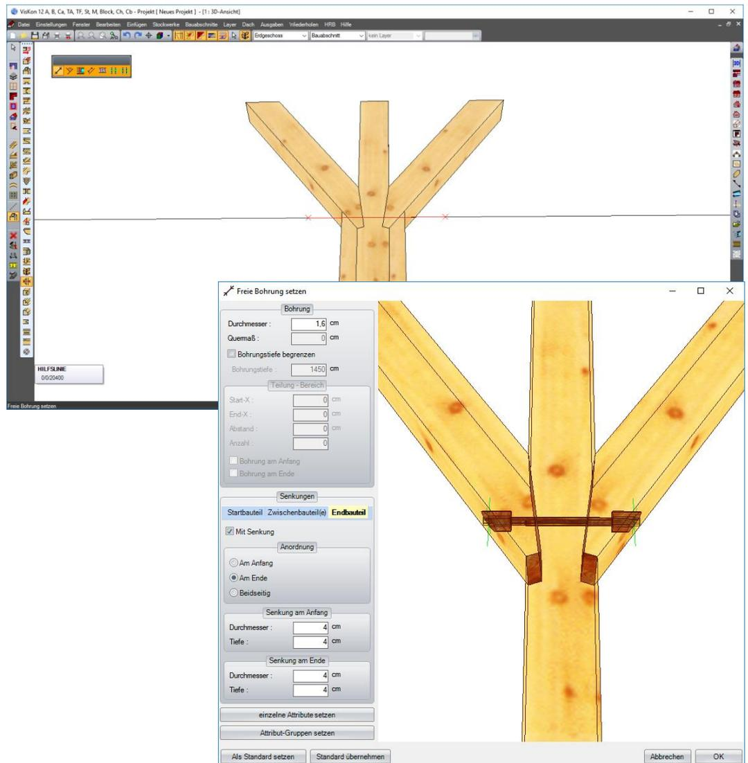
Nun werden mit der Funktion „Senkrechte Bohrung“ neue Bohrungen eingefügt. Als Bezug wird eine Fläche gewählt, in diesem Fall die Fläche des Beiholzes. Von hier aus werden die entsprechenden Abstandswerte eingegeben. In unserem Fall können diese dem nachfolgendem Bild entnommen werden. Weitere Bohrungen können analog gesetzt werden, bis man ein ähnliches Ergebnis wie im fertigen Projekt erhält.
