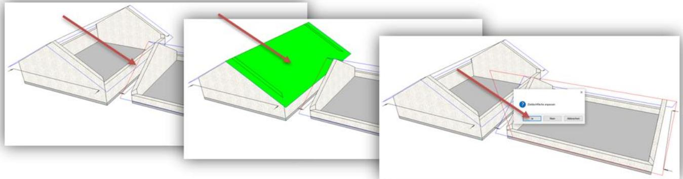
1. Die Dachkante auswählen welche angepasst werden soll; 2. Zielfläche wählen an die angepasst werden soll; 3. die sich öffnenden Fenster Zielfläche anpassen und Referenzlinie verwenden, mit Ja bestätigen. Bei dieser Anpassung wird die gesamte Dachkante auf die Zielebene angepasst. Um nun den Traufbereich der Anbaufläche weiter anzupassen, nutzen Sie die Funktion:
