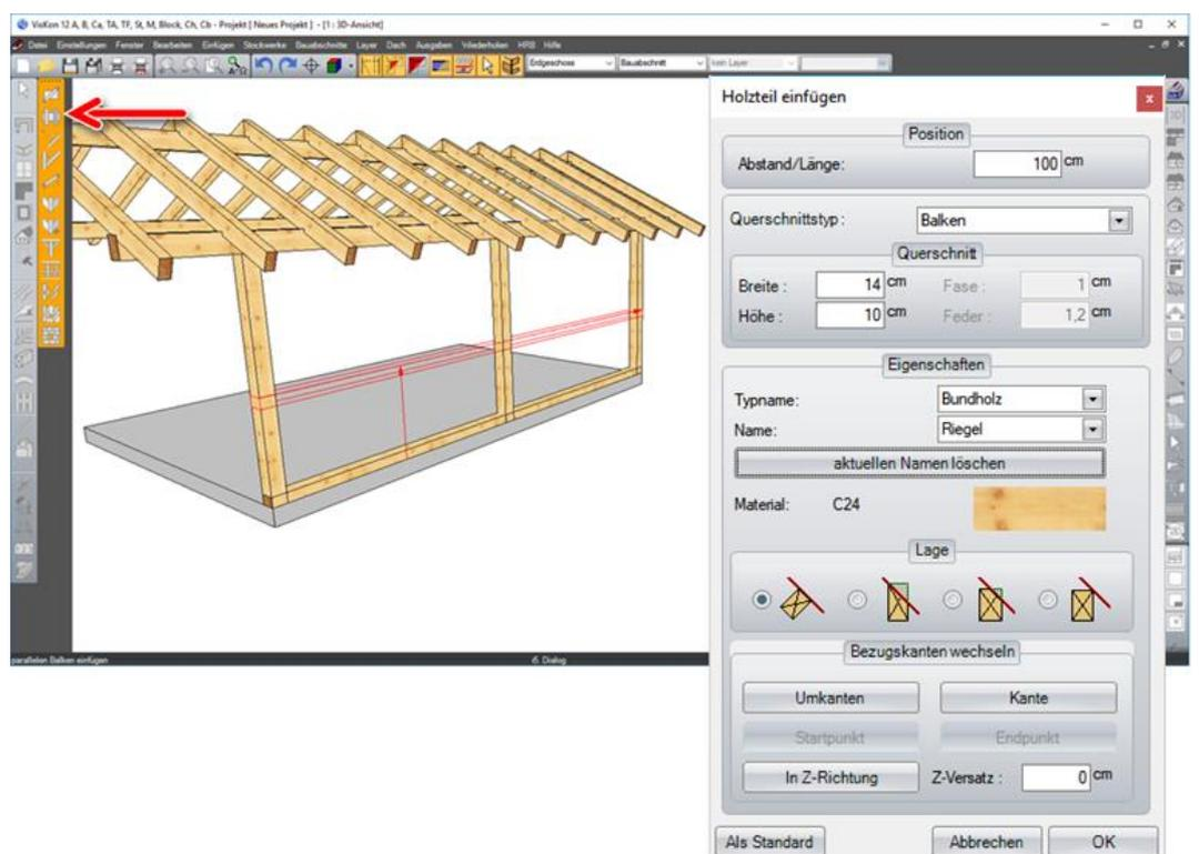
Nun werden noch zwei Kopfbänder mit Winkel an Bundseite ausgerichtet erzeugt. Die Werte können unten entnommen werden.
