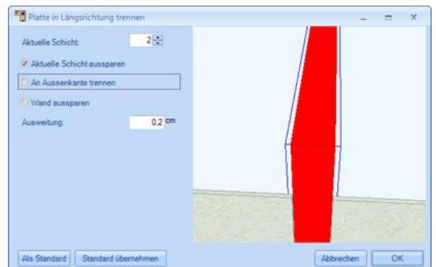
Bei Wand aussparen wird die Platte an der gesamten Wand ausgeschnitten
