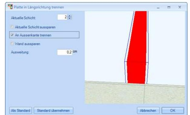
Aktuelle Schicht aussparen schneidet die Platte an der oben eingestellten Schicht komplett aus.
