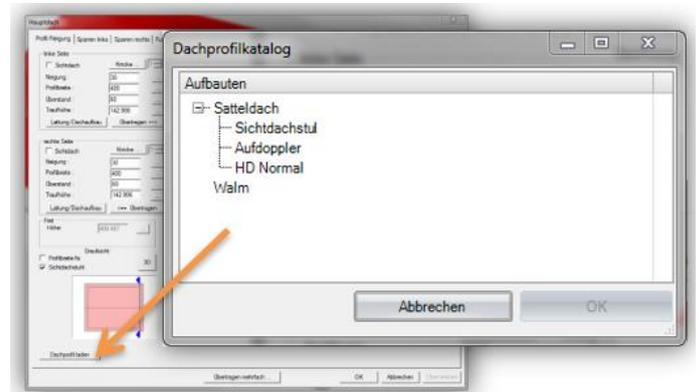
Zum anderen können Sie direkt im Dachprofilkatalog Profile vordefinieren. Öffnen Sie dazu den Dachprofilkatalog über folgende oben liegenden Reiter:
