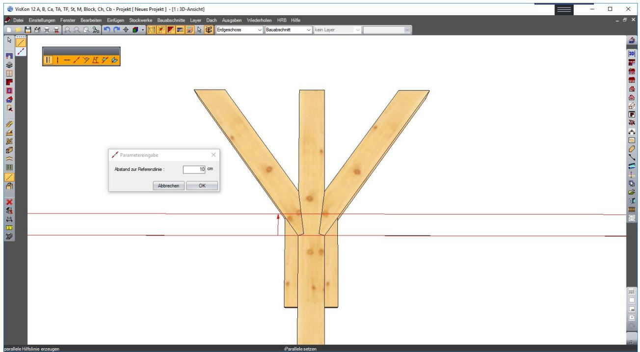
Eine weitere parallele Hilfslinie mit der Hilfslinie 2 als Bundseite und Abstand 6 cm wird nun erzeugt. Diese Hilfslinie liefert nun Start- und Endpunkt für unsere Bohrung.
