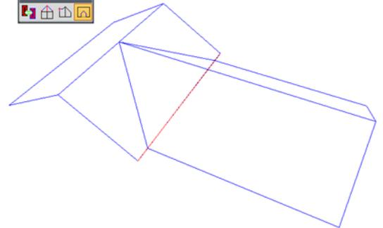
Als nächstes wählen Sie die Punkte an die die Öffnung erzeugt werden soll, wobei sie Punkt eins und zwei kurz anklicken, und beim letzten Punkt die linke Maustaste so lange gedrückt halten dass das Pluszeichen neben der Maus verschwindet. Anschließend noch mal kurz mit der linken Maustaste bestätigen.
