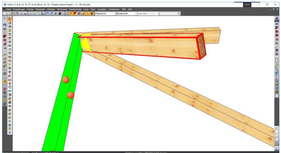
Analog wird das schräge Holz auf der gegenüberliegenden Seite angepasst. Hier ist im Dialogfenster zu beachten, dass ein Haken bei „Hexenschnitt als weiteren Abschnitt hinzufügen“ - wie im nächsten Bild gezeigt - gesetzt wird.
