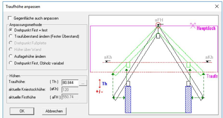
Die Traufhöhe kann nach Auswahl der entsprechenden Anpassungsmethode entweder durch Eingabe eines Wertes oder durch Anklicken einer Dachkante oder Pfette in der Draufsicht angepasst werden. Der Grundriss öffnet sich durch klicken auf den Button hinter der Traufhöhe im Anpassungsdialog.
