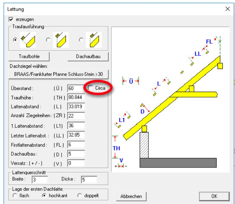
Unter dem Button Dachaufbau finden Sie die Einstellungen für die einzelnen Flächen (Sichtdachfläche, Rohdachfläche,...). Diese können im Projekt mit der F9-Taste berechnet und angezeigt werden. Über den Button Dachaufbau wählen kann der Dachaufbau aus dem Dachaufbautenkatalog übernommen werden.
