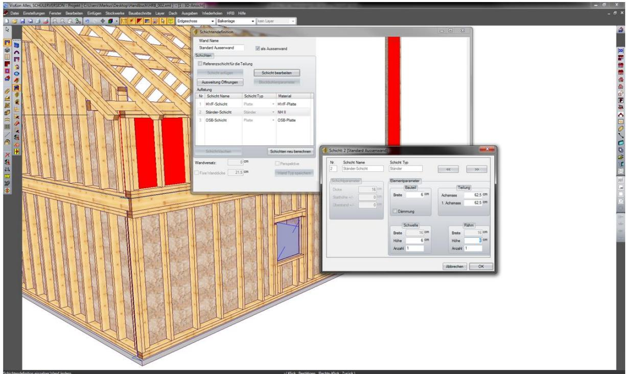
Mit Schichtdefinition einer Wand bearbeiten können Sie bestehende Wände einfach und schnell ändern, wenn einige Wände andere Querschnitte und/oder unterschiedliche Anzahlen der Schwellen und Rähme benötigen, ohne für jede Änderung ein separates Wandsystem anlegen zu müssen. Die Geometrie der Wand wird dadurch nicht verändert.
