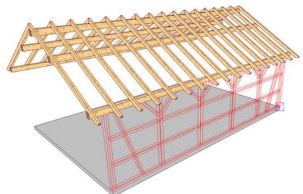
Beim Stiel werden neben den Abmessungen auch die Anzahl der Stiele festgelegt. Beim Start- und Endpunkt werden die vorher angeklickten Werte übernommen. Diese können aber hier noch verändert werden. Das Achsmaß der Stiele wird errechnet und hier angezeigt.
