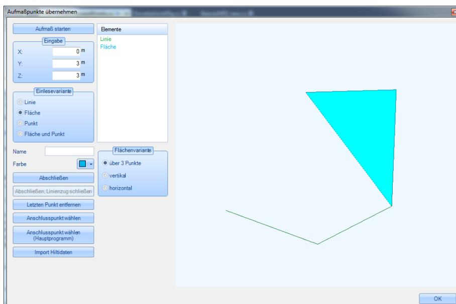
weiteren Punkte werden dann auf diese Ebene lotrecht projiziert. Das Projizieren resultiert daraus, weil in der Praxis die reell gemessenen Punkte ja auf einem Bauteil sind und diese auch z.B. Rücksprünge haben kann wie eine außen liegende Fußfette zur Außenwand. Wenn die Variante Fläche und Punkt gewählt ist, dann werden die reell gemessenen Punkte noch zusätzlich als 3D-Punkt erzeugt.
