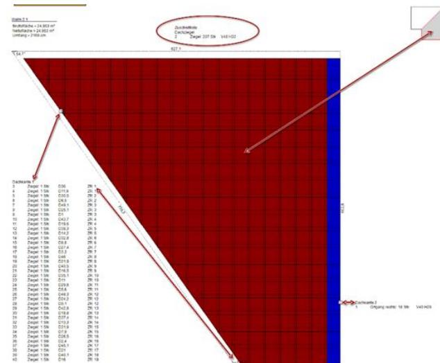
Neue Dachziegelnummerierung nach Dachkanten- und Ziegelreihen-System ungestellt, was eine leichtere und übersichtlichere Auswertung der Dachziegel ermöglicht.
