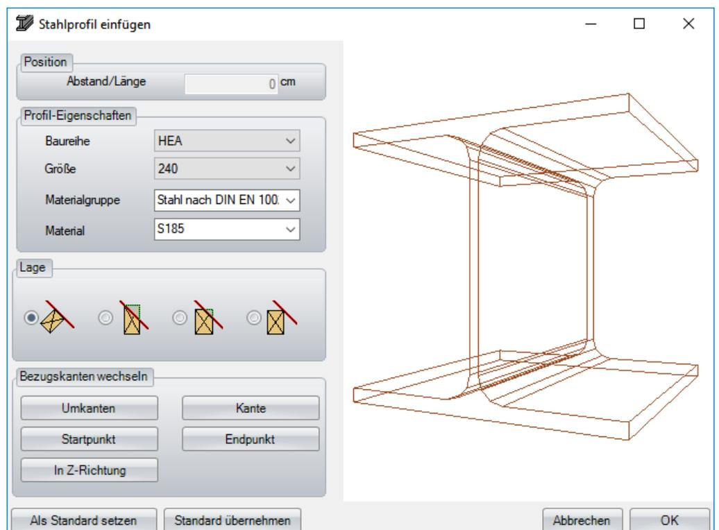
Im nächsten Schritt soll mit der Funktion „Stahlträger einfügen“ „parallel an Bundseite ausgerichtet“ ein Stahlträger parallel zur Seitenfläche des ersten Trägers an die Unterkante der Mittelfetten eingefügt werden.
