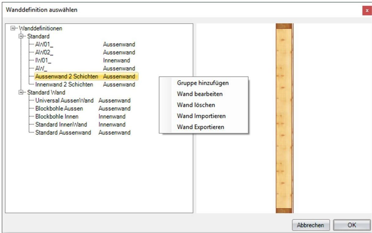
In diesem Dialog werden die Einstellungen der ausgewählten Wanddefinition aufgezeigt. Mit einem Rechtsklick in das Auswahl Fenster können Sie neue Gruppen anlegen oder Löschen, eine vorhandene Schichtdefinition bearbeiten, nicht mehr benötigte Wandsysteme Löschen oder für ein weiteres Visikon System Importieren und Exportieren.
