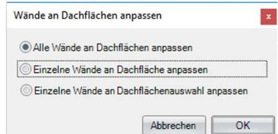
Nach Bestätigung mit OK kann im nächsten Fenster zunächst ausgewählt werden, für welche Schicht die Anpassung vorgenommen werden soll. Der Schichtaufbau verläuft von außen nach innen entsprechend der Schichtdefinition (siehe dazu Funktion Neue Schichtdefinition erstellen). Wird keine Anpassung an die Dachhaut gewünscht, kann der Haken bei Wandhöhe bis Dachhaut anpassen entfernt und bei Obergrenze Wandhöhe die entsprechende Höhe eingegeben werden.
