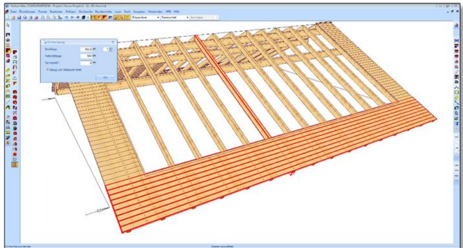
Nach Bestätigen des Dialogs mit „OK“ wird die Schalung am gewählten Sparren getrennt. Die Schaltfläche kann weitere Male ausgeführt werden, um die Schalung von der anderen Dachseite her zu trennen. Dazu den Haken bei Bezug vom Startpunkt Brett (Startpunkt ist immer links) entfernen. Im Dialog kann man außerdem eine Rohbrettlänge definieren, die gewünschte Länge frei eingeben oder durch das eingestellte Sprungmaß berechnen.
