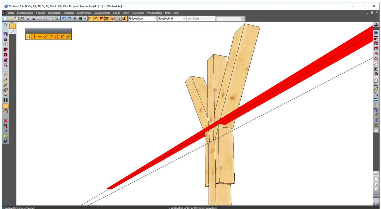
Mit der Funktion „Bohrung 2 Punkte“ werden nun die zwei Eindringpunkte in das Holz gewählt und doppelgeklickt. Im erscheinenden Fenster können noch Einstellungen zur Bohrung und zur Senkung getätigt werden.
