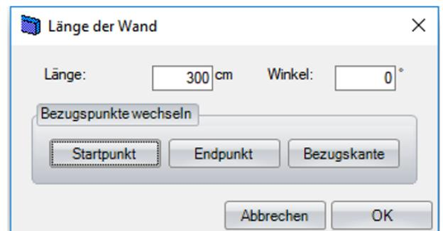
2. Variante: Nach Anklicken des Startpunktes können Sie mit einem Rechtsklick die Lage der Wand (senkrecht, waagrecht, winkel, frei) bestimmen. Die Wand bleibt jetzt automatisch in der ausgewählten Lage. Jetzt kann der entsprechende Endpunkt der Wand angeklickt werden.
