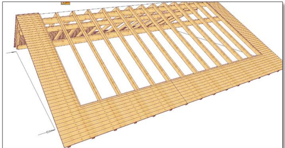
Die Sichtschalung im Ortgangbereich können Sie ebenfalls optimieren. Dazu die Schalung aussuchen und den Sparren anwählen. Im Beispiel wäre die Brettlänge für die Schalung 86,8 cm. Mit dem Sprungmaß von 30 cm ergibt sich daraus eine Länge von 90 cm. Über die Anzahl der Bretter, die man rechts oben wählen kann, ergibt sich eine Rohbrettlänge von 450 cm. Das eingegebene Maß der Rohbrettlänge muss vor der Auswahl des Sparrens mit einem Klick darauf erfolgen.
