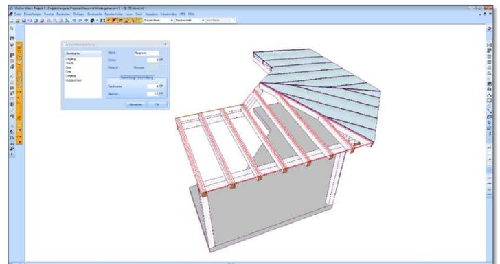
Dachkanten aufgelistet. Für jede der Dachkanten kann eine Verschiebung (Überstand oder Rücksprung) der erzeugten Bauteile eingestellt werden. Somit kann man z. B. bei der Traufkante einen Überstand hinterlegen. Unter der Einstellung Sparren wird eine Aufweitung der einzelnen Bauteile zueinander festgelegt. Das Maß wird aus der Sparrenmitte berechnet. Da diese Bauteile 3D-Flächen sind, lassen sie sich in der 3D-Flächenliste oder als Zeichnung auswerten.
