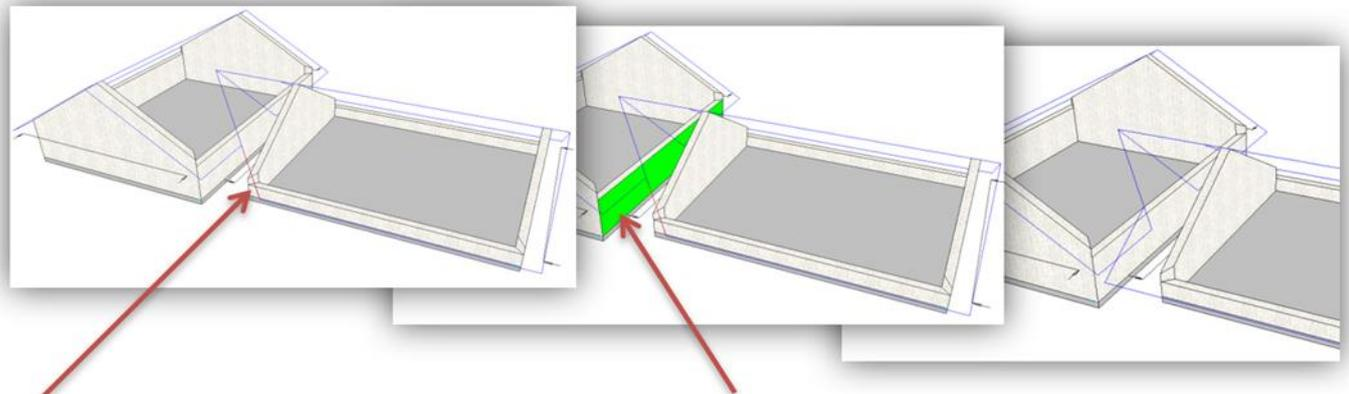
1. Die Dachkantenseite auswählen bei der die Bearbeitung entstehen soll; 2. die Zielebene, in diesem Fall die Außenkante Wand. Zusätzlich zu Dachflächen und Wänden können auch Hilfslinien und Dachkanten als Zielebene genutzt werden.
