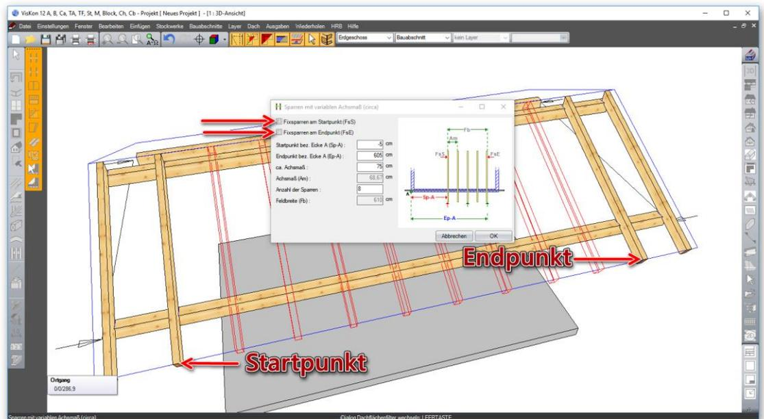
Nun werden die Sparren noch in die andere Dachseite kopiert. Dies geschieht mit der Funktion Sparren von Fläche in Fläche kopieren. Dazu erst die Fläche anklicken, aus der kopiert wird, und anschließend die Zielfläche.
