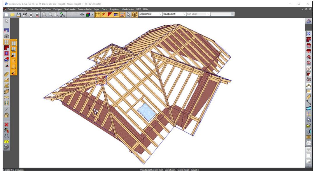
Die Eingabe wird über den Dachassistenten vorgenommen (Anlegen eines neuen Projektes). Für das Projekt erzeugen Sie das Dach mit frei wählbaren Querschnitten bzw. Abmessungen. Nur der Anbau erhält statt des Walmes einen Ortgang. Um dies zu erreichen, wechseln Sie auf die Profilseite des Anbaus und klicken dann die Schaltfläche Profil eingeben.
