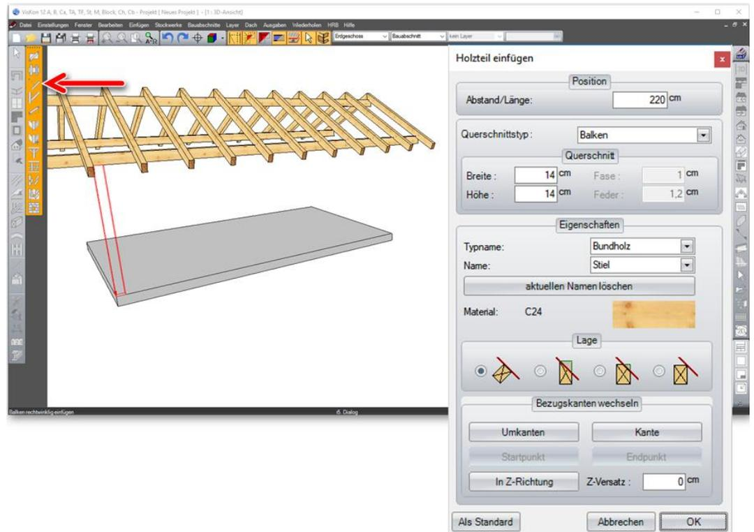
Eine weitere Ecksäule am rechten Giebel und eine Säule genau mittig wird über die Auswahl parallel an Bundseite ausgerichtet erzeugt. Die Bundseite bleibt gleich; als Bezugskante wird jedoch die Außenkante der bereits erzeugten Säule gewählt. Im Eingabefenster können die genauen Werte eingetragen werden.
