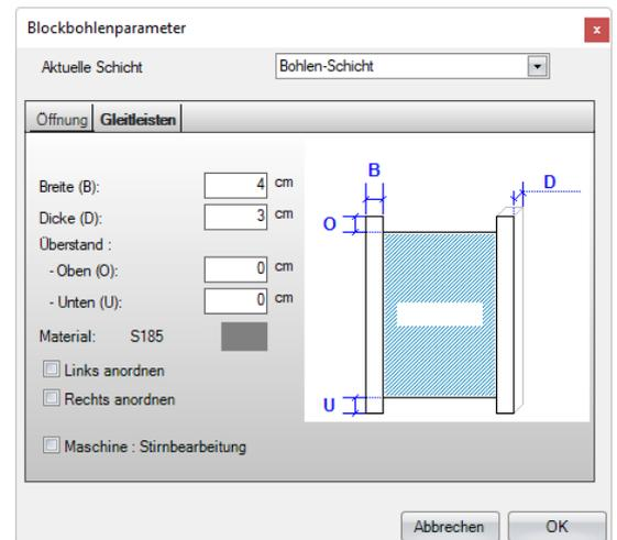
Bei Öffnung wird eingestellt, wie die Fensteröffnungen beim Ausschneiden der Blockbohlen berücksichtigt werden. Unter Gleitleisten werden die Einstellungen der Gleitleisten definiert.
